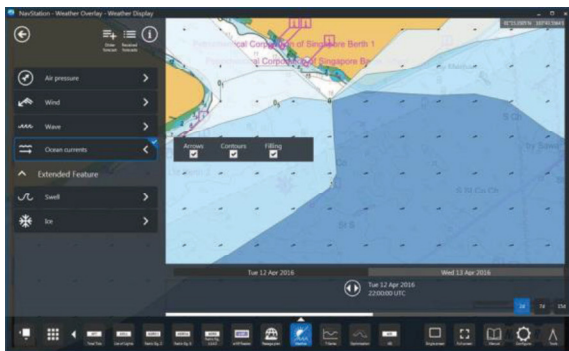
Fig. 7. Correntes de alta resolução previstas pela Hidromod com o modelo MOHID (Bartolomeu et al., 2014) sobrepostas à carta náutica digital na plataforma via plataforma NavStation.
